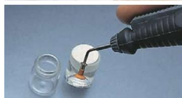
Erem 3000 серии предлагает систему вакуумного микроманипулятора для точного удержания миниатюрных компонентов, так же хорошо как и плоских частей. Для использования в механических сборках, лабораториях и проч.
